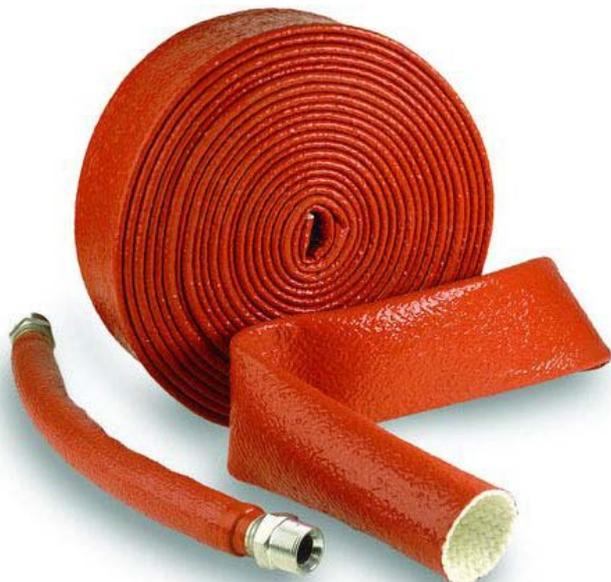
Рукав AEROSTYLE PYROJACKET® выдерживает продолжительное воздействие при температуре до 260°C, температуру до 1090°C – в течение 15-20 минут и температуру до 1650 °C в течение 15-30 секунд. При воздействии открытого пламени силиконовый компонент покрытия рукава превращается в корку, образуя защитный огнеупорный слой из оксида кремния.
