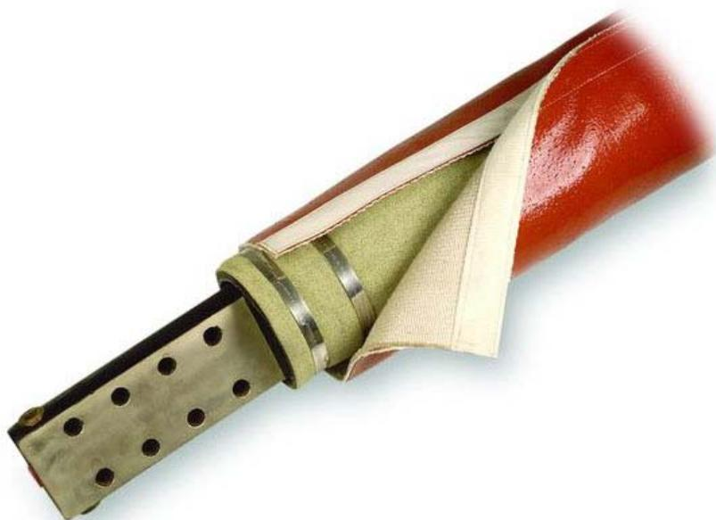
Оболочка изготавливается по размерам заказчика с использованием защитной ткани PYROBLANKET 96 OZ и огнестойкого замка-липучки Nomex, что позволяет устанавливать защитную оболочку, без отсоединения кабеля.
