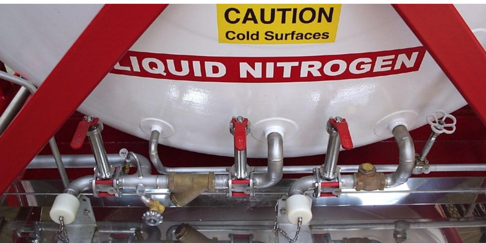
Криогенные вентили, установленные на передвижных резервуарах
