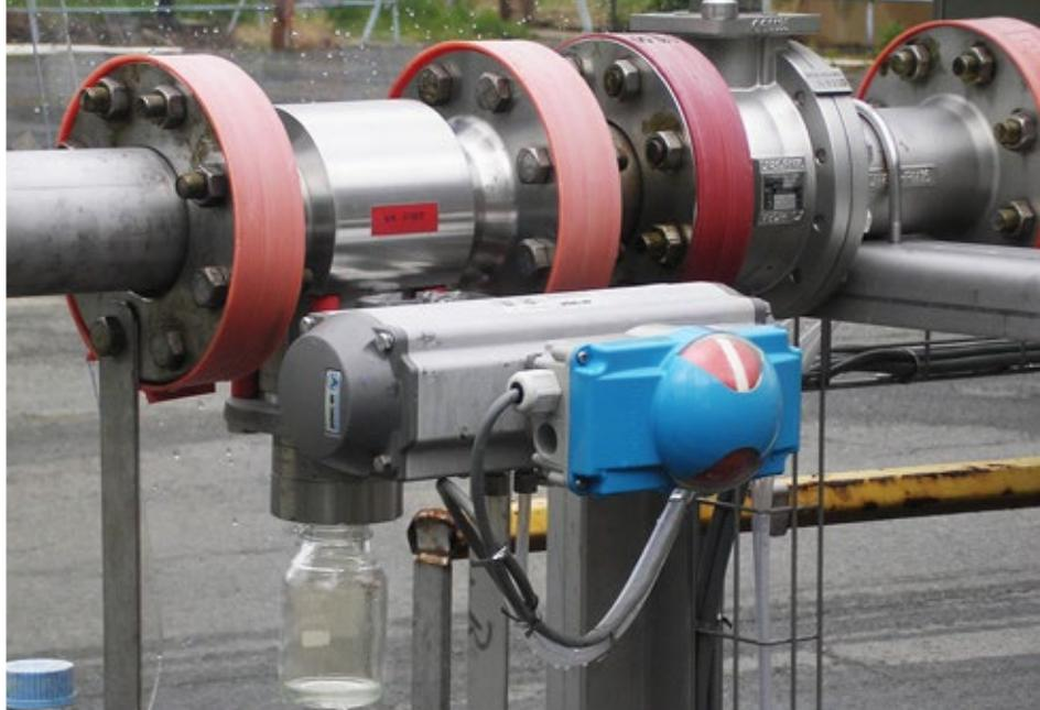
Стальное приспособление для взятия проб для контроля качества
