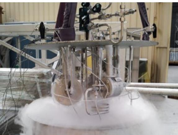
Тестирование герметичности на предельно низких температурах
