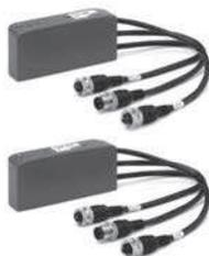
Это модуль расширения подсети SPI-Ethernet. Он может быть использован со всеми островами с многостырьковыми версиями, имеющими коннектор 25-контактный Sub-D (серия F, 3 и HN) и с островом серии HN с 37-контактным Sub-D. Он имеет коннектор M12A 4 pin Male для питания силовых и логических цепей подключаемых распределителей острова и два M12D 5-pin Female коннектора подсети BUS IN и BUS OUT, показывая их рабочее состояние с помощью светодиодов.
