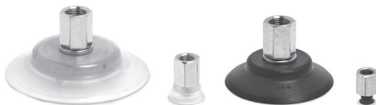
Плоские вакуумные присоски Серия VTCF прочные и износостойкие. Состоят из ниппеля и резиновой части, которые поставляются отдельно. В присосках с диаметром до 50 мм ниппель монтируется непосредственно в резиновую часть. В присосках с диаметром более 60 мм ниппель монтируется в крепёжную плиту, которая вулканизирована в резиновую часть.
