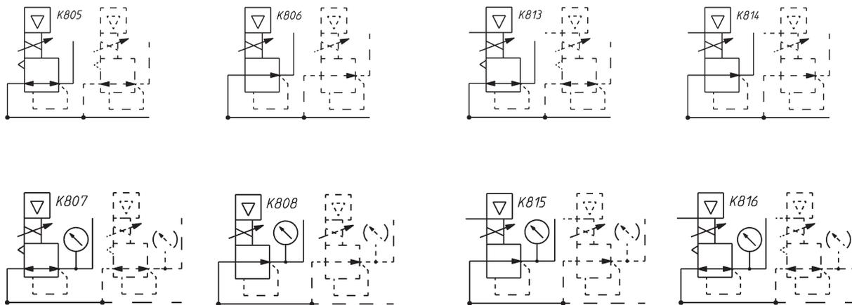
K805 = модульный, со сбросом, с электроуправлением
