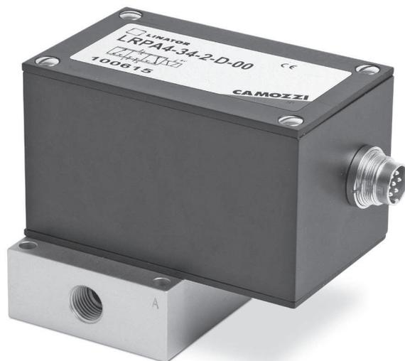
Сервораспределители LRPA4 являются интегрированной сервопневматической системой для высокоточных цепей управления давлением в пневматических системах. Устройство состоит из 3х-линейного золотникового сервораспределителя, датчика давления, электронного ПИД-регулятора и схемы управления сервораспределителем.
